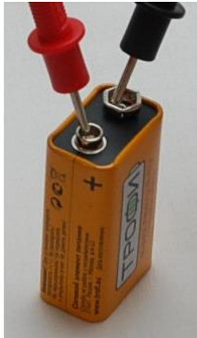
На экране мультиметра отобразится напряжение Кроны.
