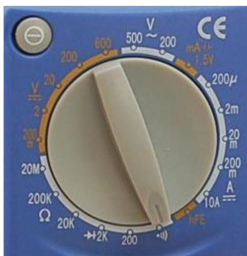
Коснитесь щупами друг друга. Раздастся писк! Это означает, что цепь замкнута и по ней протекает электрический ток. Ток вытекает из плюсовой клеммы Кроны, установленной в мультиметре, протекает по красному щупу, затем по черному, попадает в зуммер, который издает пронзительный писк, а потом снова затекает в Крону через минусовую клемму. Крона хитрым химическим способом снова разгоняет ток, и он опять вытекает из ее плюсовой клеммы.
