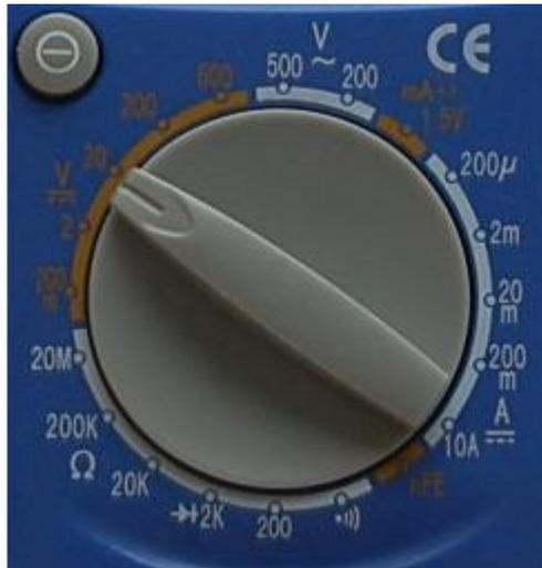
На рисунке переключатель показывает на 20. Это означает, что в этом режиме мы сможем измерить напряжение от 0В до 20В. Для того чтобы измерить напряжение Кроны следует коснуться черным минусовым щупом отрицательной клеммы Кроны (—), а красным щупом положительной клеммы (+).
