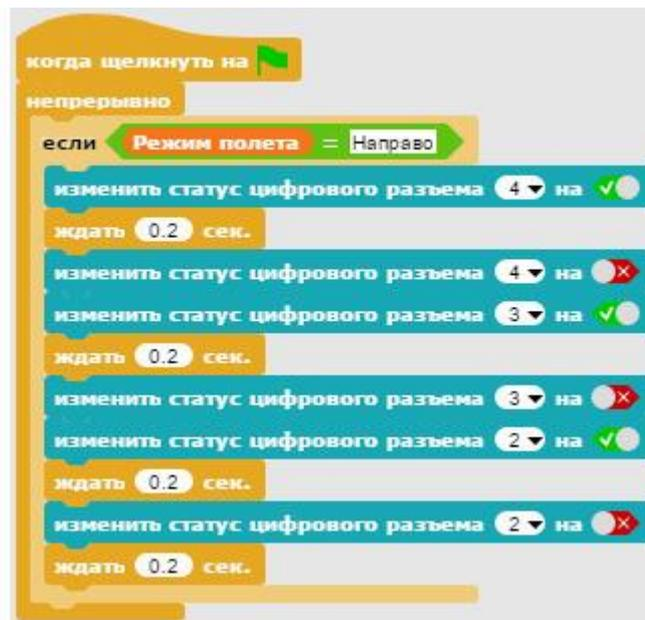
В этом случае на выводы 4, 3 и 2 поочередно подается и снимается напряжение с задержкой в одну пятую долю секунды. При этом зеленые светодиоды загораются по очереди, указывая направление поворота корабля.
