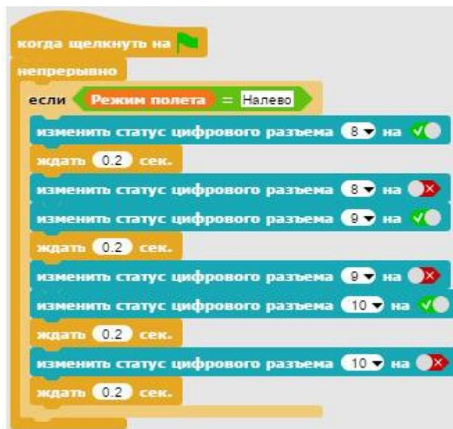
В этом случае на выводы 8, 9 и 10 поочередно подается и снимается напряжение с задержкой в одну пятую долю секунды. При этом красные светодиоды загораются по очереди, указывая направление поворота корабля.
